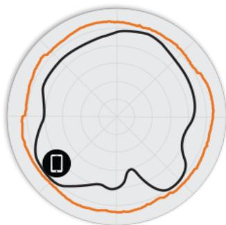
РИСУНОК 3 Азимутальная плоскость 5 ГГц T310d Диаграммы направленности антенны
