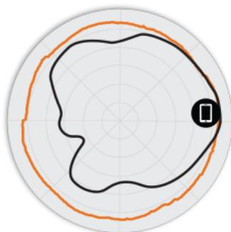
РИСУНОК 4 Вертикальная плоскость 2,4 ГГц T310d Диаграммы направленности антенны
