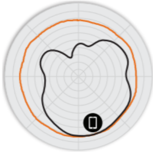
РИСУНОК 2 Азимутальная плоскость 2,4 ГГц C110 Диаграммы направленности антенны
