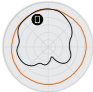
РИСУНОК 3 Азимутальная плоскость 5 ГГц C110 Диаграммы направленности антенны
