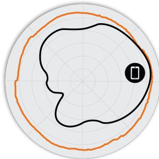
РИСУНОК 4 Вертикальная плоскость 2,4 ГГц E510 Диаграммы направленности антенны
