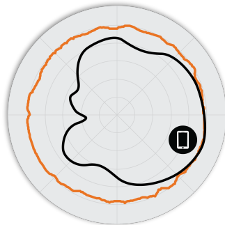
РИСУНОК 3 Азимутальная плоскость 5 ГГц M510 Диаграммы направленности антенны
