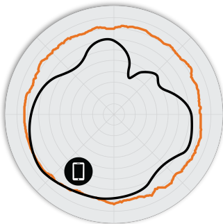
РИСУНОК 2 Азимутальная плоскость 2,4 ГГц M510 Диаграммы направленности антенны
